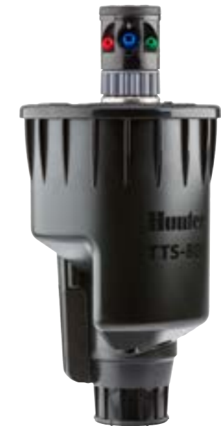
HTGT-885-E-48-P8 Anschluss: 1 1/2"-ACME Innengewinde Aufsteigerhöhe: 9,5 cm Gesamthöhe: 30 cm Flanschdurchmesser: 18 cm
